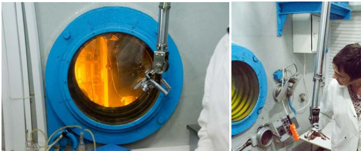
Гаряча камера з металевою рукою-маніпулятором для дистанційної роботи з радіоактивними матеріалами. ІЯД НАНУ. Ядерний реактор ВВР-М. 30 червня 2016 р. Фото О. Курмаз
